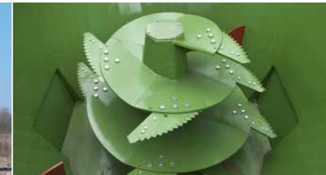
Keverőcsiga kilenc fogazott késsel
