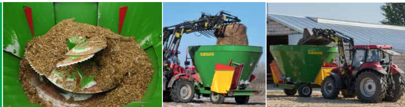
Az optimális kialakítású csiga növeli a keverés hatékonyságát
