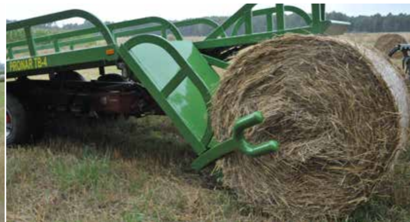
A széles rakfelület (2550 mm) két sor bála felrakását teszi lehetővé
