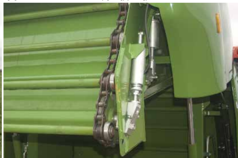
A görgős lánc lehetővé teszi száraz és nedves anyagok begyűjtését egyaránt
