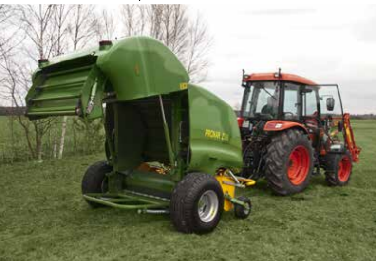
Fix kamrás bálázó lánchajtással
