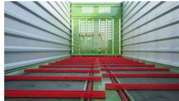
Fapadlózat fémsínekkel a szállítószalag láncjai számára
