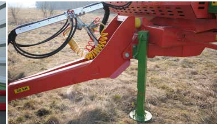
Vonórúd-alátámasztás: egy darabból álló, hidraulikus támasztóállal
