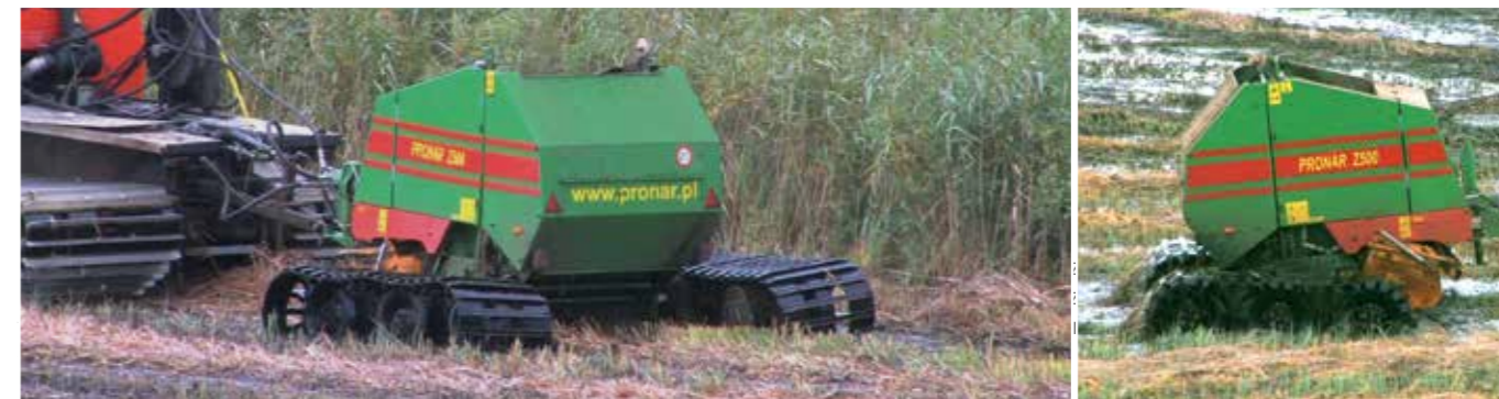
PRONAR Z500G körbálázó – a láncfalpas járószerkezet lehetővé teszi a nedves talajon történő munkavégzést
