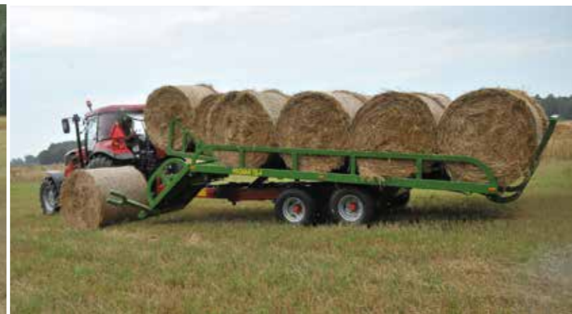
A széles rakfelület (2550 mm) két sor bála felrakását teszi lehetővé
