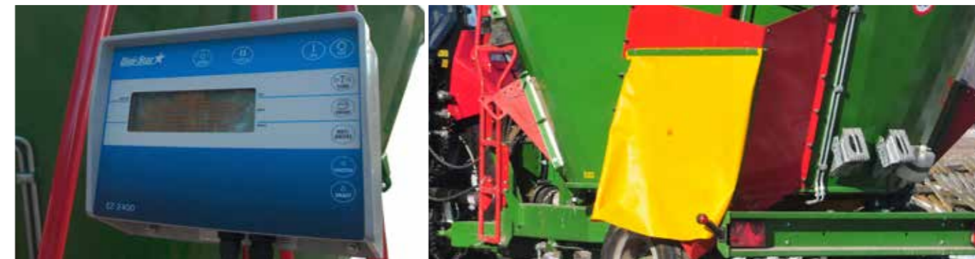
LCD kijelzőn követheti a takarmány tömegét és az üzemidőt
