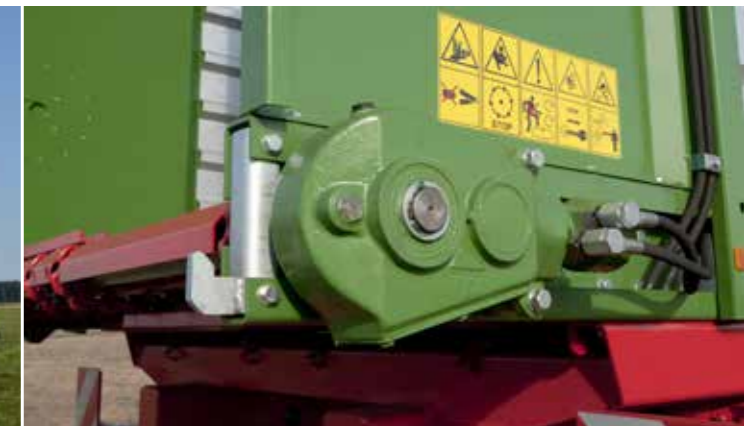
Vonórúd-alátámasztás: egy darabból álló, hidraulikus támasztóállal
