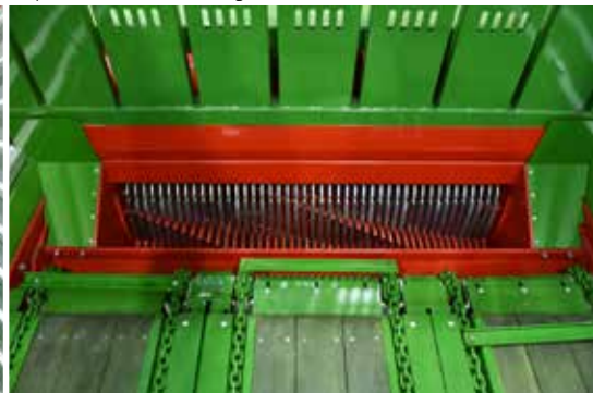
Kopásálló acélból készült adagolórotor
