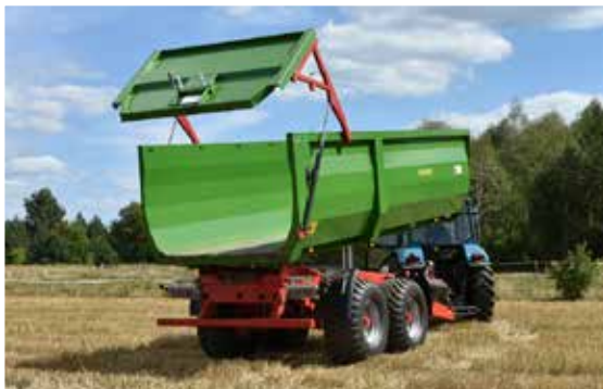
Rakfelület az oldalfalakat merevítő függőleges bordákkal. Hidraulikus működtetésű hátfal
