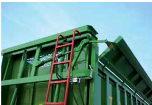
Hidraulikus működtetésű oldalsó peremelemz automata zárórendszerrel
