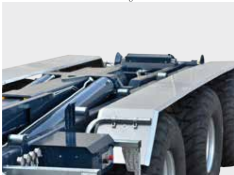
Szilárd váz két hidraulikus munkahengerrel
