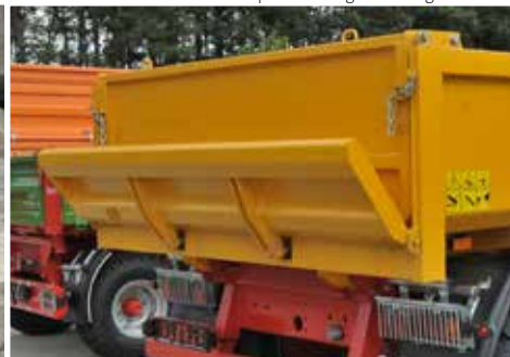
Hidraulikus működtetésű hátsó panel és kiegészítő lengő hátfal
