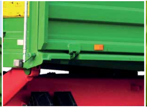
Oldalfalak hidraulikus reteszoló és emelő rendszerrel (T683H)
