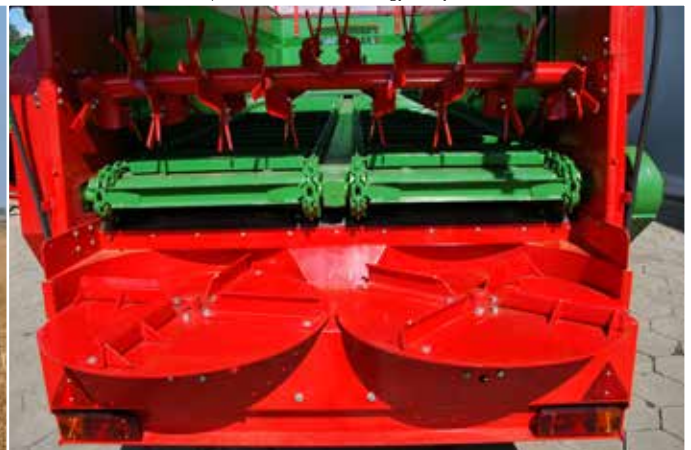
PRONAR N262/1 - AH20 adapter két szélesre szóró kiegyensúlyozott tárcsával
