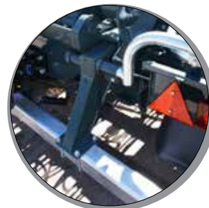
Hidraulikusan kitolható, horganyzott aláfutástámlók Munkahengerek távolsága - 70 cm.
