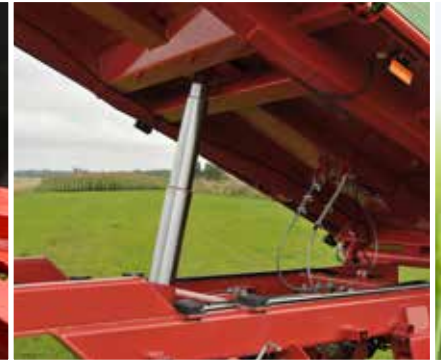
Alvázkeret nagy szilárdságú acélból készült, téglalap keresztmetszetű zártszelvény profilokból
