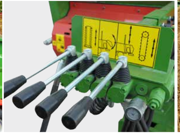
N262/1 trágyaszóró- hidraulikus kihordólánc-hajtással
