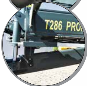
Hidraulikus vonórúd-alátámasztás magasságállítással
