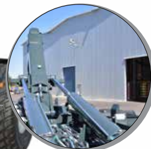
Két fő munkahenger növeli a váz szilárdságát és stabilitását
