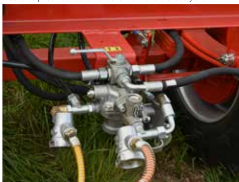
Kétkörös pneumatikus fékrendszer kézi fékerő-szabályozóval
