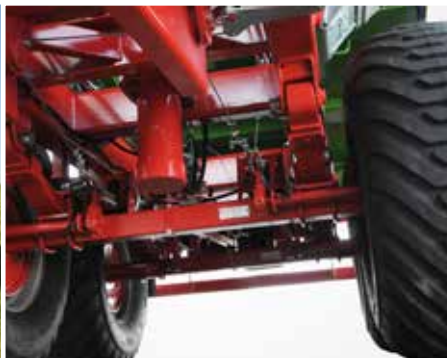
A parabola-laprugókra szerelt erős és robusztus alváz megkönnyíti a nehéz terepen történő szállítást
