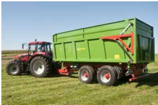
Trapéz alakú, 23 m 3 -es rakodótér (magasítókkal)
