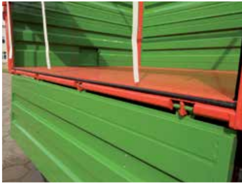
A padlón lévő hornyokban elhelyezett cserélhető gumitömítés teljes zárást biztosít (T680U)
