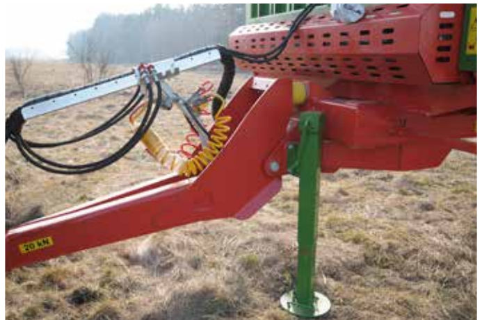
Vonórúd-alátámasztás egy darabból álló, hidraulikus támasztólábbal
