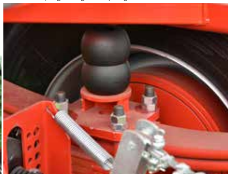
Parabola-laprugók lengéscsillapító gumibakokkal
