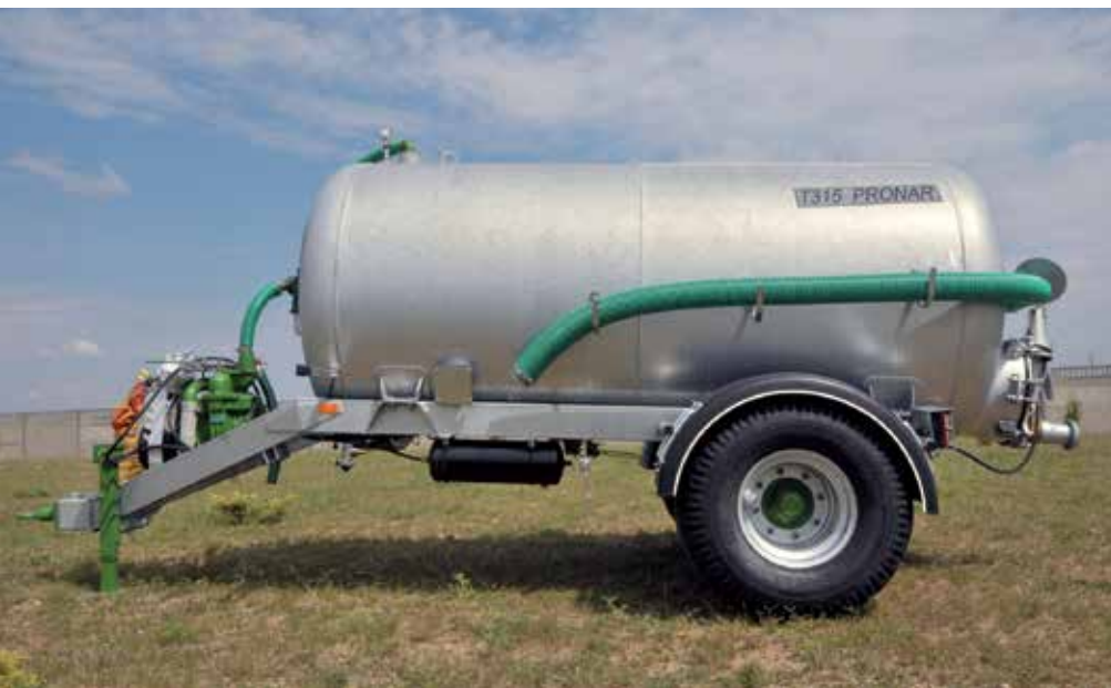
A pótkocsi egy egytengelyes alvából és a hozzá csatlakoztatott tartályból áll.
