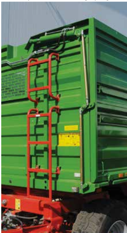
Az oldalfal nyitását hidraulika vezérli és gátolja meg (T680H) Pótkerécsörölő az alvó alatt
