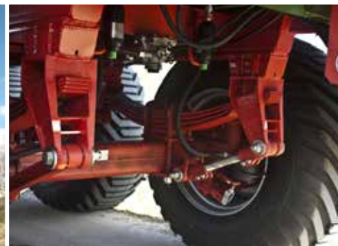
Háromtengelyes futómű 6 parabola-laprugóval
