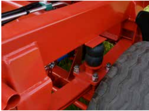
Parabola-laprugók lengéscsillapító gumibakkokkal
