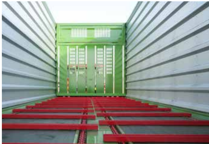
Fa deszkákból készült padlózat fémsínekkel a szállítószalag láncjai számára
