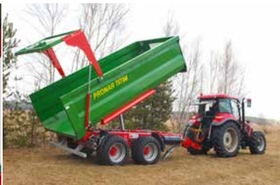
Profilalakból készült rakfelület és megerősített felső perem (T679M)
