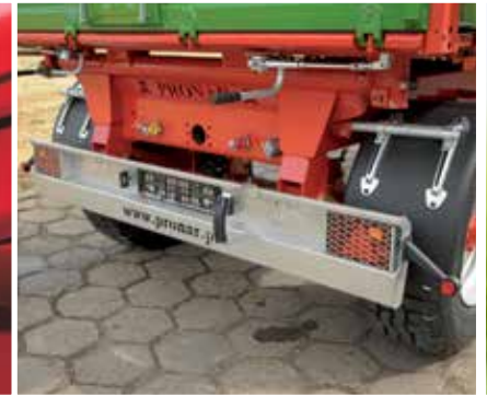
Erős hátsó ütköző védőrácscsal ellátott LED lámpákkal
