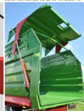
Hidraulikusan nyitható hátfal automatikus zárva tartó rendszerrel
