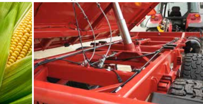
Alváz zártszelvény profilokból
