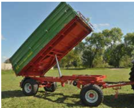
Univerzális oldalfalnyitó szerkezettel szerelt, trapéz alakú rakfelület (hátsó 50 mm-rel szélesebb, mint elől)
