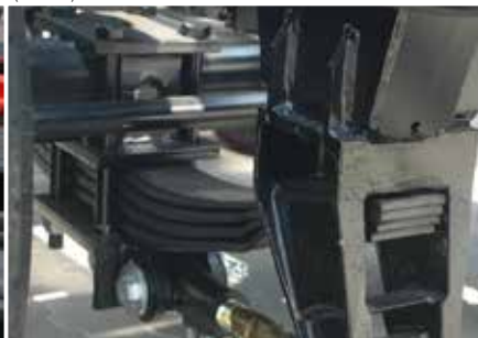
Tandem futómű 4 parabolarugóval. 1810 mm tengelytáv (T285/1)
