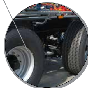
Merev első tengely és passzív kormányzású hátsó tengely hidraulikus elfordulástámlával
