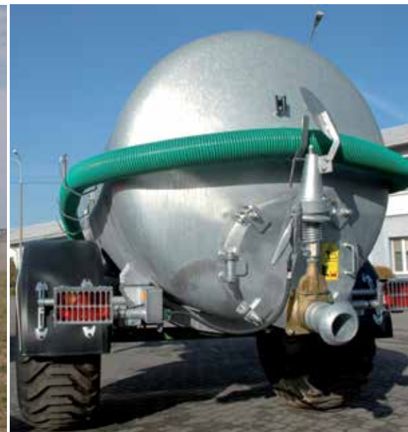
Hidraulikusan nyitható hátsó szelep (4") - a traktorról vezérelhető.
