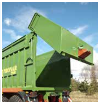
Hidraulikus működtetésű hátfal automata reteszelőrendszerrel
