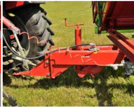
Kerékek tartókkal és szerviztámasszal a rakfelülethez Merev vonórúd a traktor alsó és felső vonószerkezetéhez
