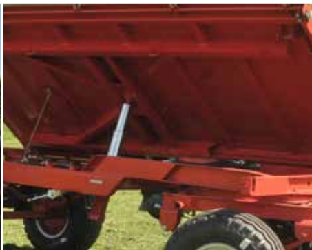
Az alvázközet és a felső vázközet nagy szilárdságú anyagból készült padlóval egészül ki
