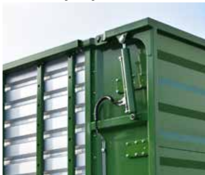
Hidraulikusan emelhető hátsó fal, a rakodótér felszerelhető adagolóhengerekkel.
