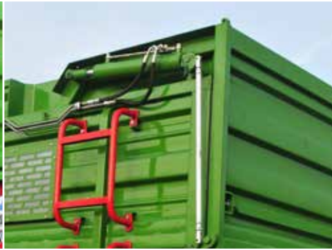
Oldalfalak hidraulikus reteszoló és emelő rendszerrel (T683H)
