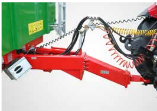
A traktor alsó vagy felső vonószerkezetéhez csatlakoztatható univerzális vonórúd
